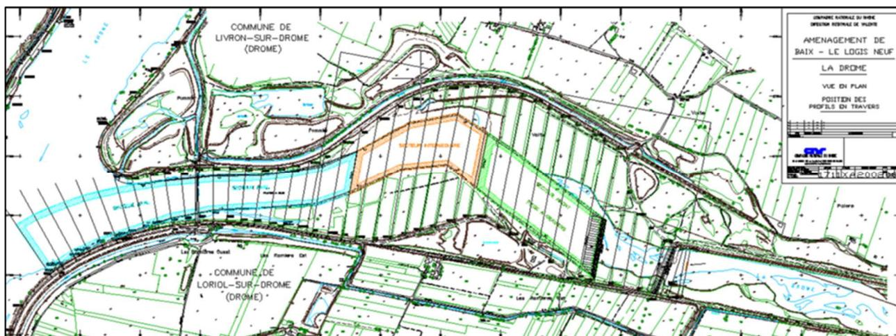
Au regard des zones draguées, la zone aval correspond à la zone d'ajutage et, en fonction des matériaux rencontrés à l'aval de la zone intermédiaire. Le dragage dit du « piège à graviers » correspond à la zone comprise entre l'aval du seuil et la fin des bancs de graviers (plus ou moins dans la zone intermédiaire).
