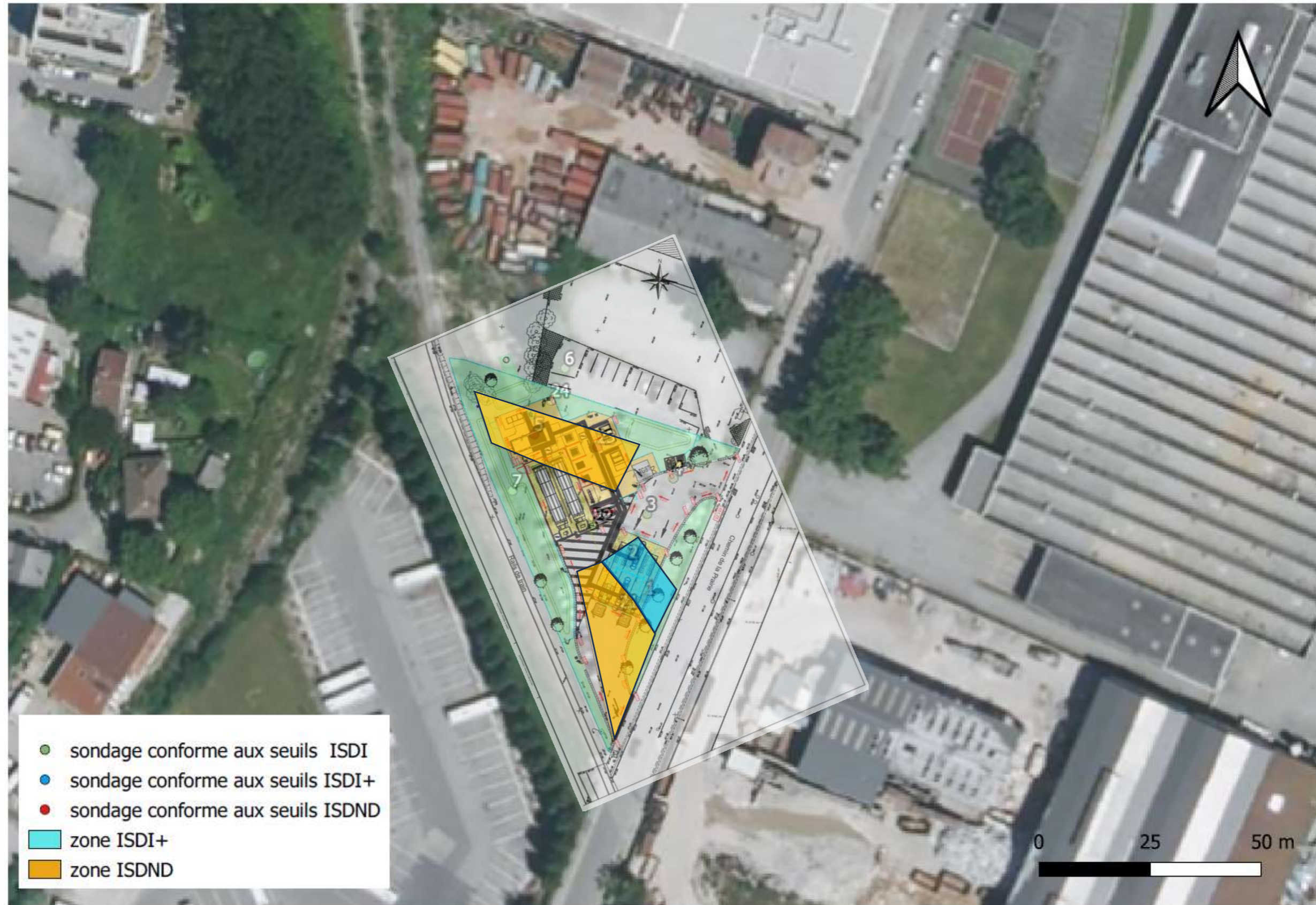
Figure 18 : Délimitation des zones d'évacuation selon la filière de traitement, avec superposition du plan de masse du projet sur le site
