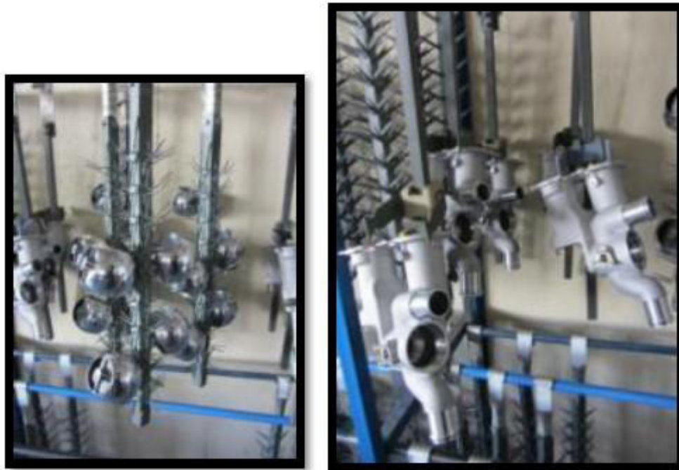
Figure 4 : Exemple de pièces traitées par la ligne chromique et OAS
