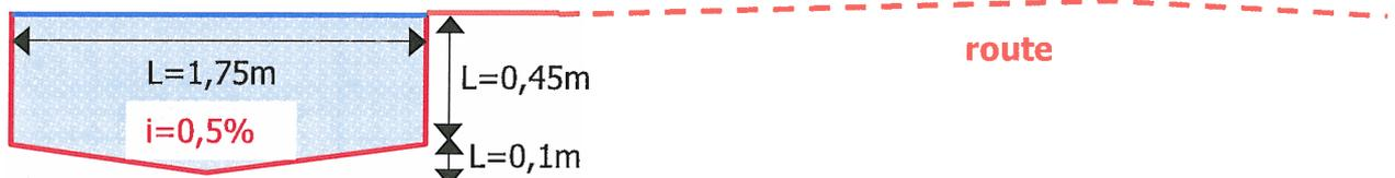
Figure 27 : gabarit type de l'ouvrage le long du RD991
