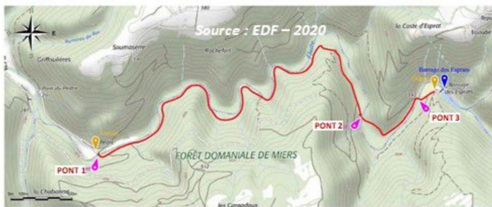
Le long du parcours, la piste franchit 3 fois l'Auze. A chaque passage se trouve un pont métallique de type BAYLEY. La circulation des poids lourds est interdite sur ces ouvrages. Les engins de chantier et les camions franchissent donc la rivière à gué à côté des ponts
