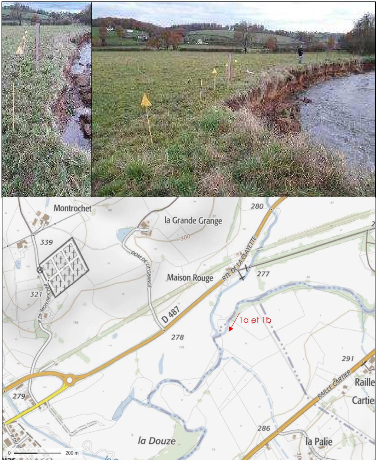
**Figure 1.** Illustration de la dynamique naturelle d'érosion du Sornin, au droit de la canalisation de GRT Gaz, désormais menacée (ressources photographiques : GRT Gaz, Novembre 2016)
