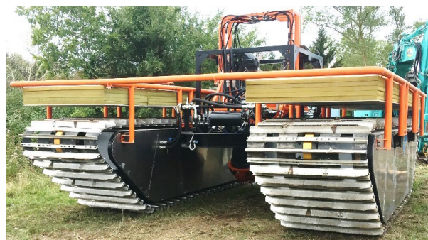
Figure 2 : Schéma de principe du projet et moyen de dragage envisagé (NESSIE = outil innovant de dragage co-développé EDF / WATERTRACKS).
