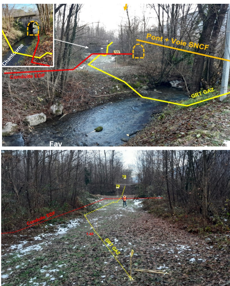
Figure 7 : Tracé de la conduite de gaz existante (jaune, suite au piquetage de fin 2020) et de la future conduite de curage (rouge) (vue depuis le chemin qui longe la rive gauche du Fay)
