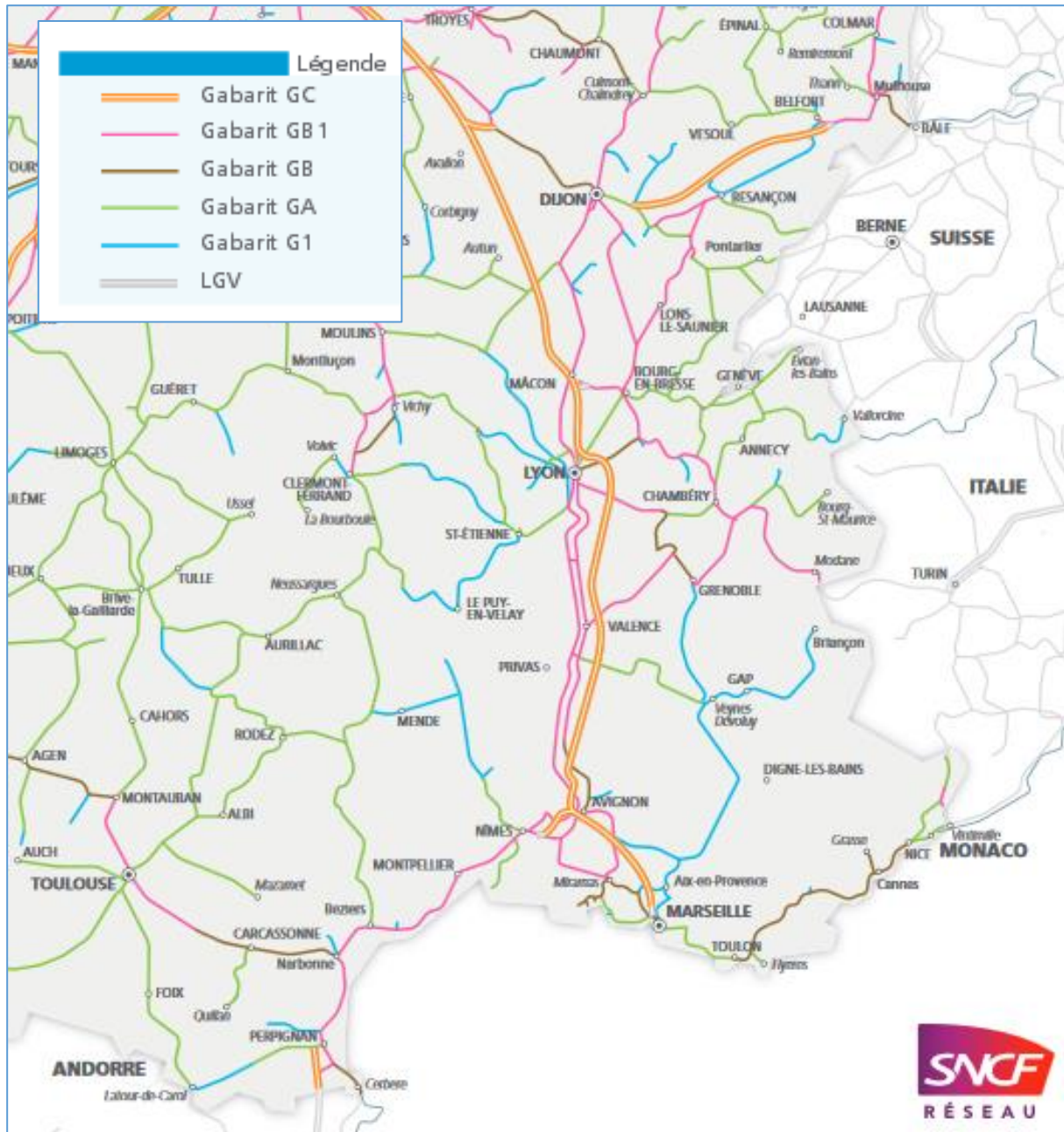
Figure 31 : Réseau ferré à gabarit
