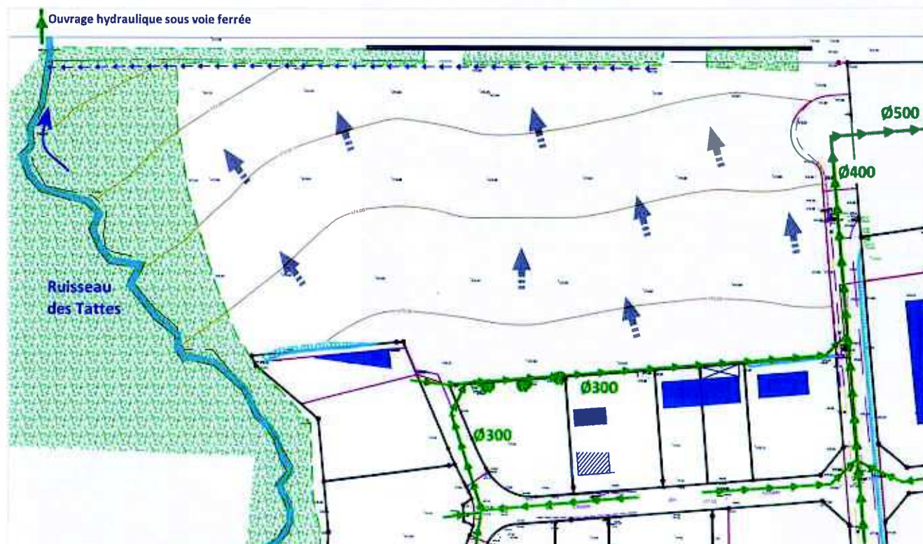
Figure 13 : Ruissellements sur l'emprise du site
