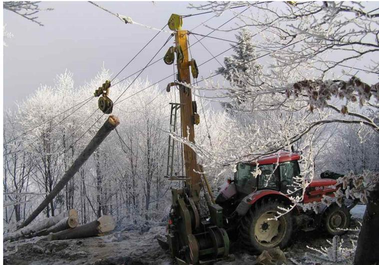
Figure 3 : Débardage par câble-mât. Source : Müller-Câble-Mât
