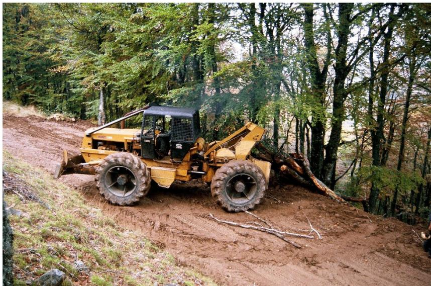
Figure 1 : Débardage par tracteur débusqueur. Source : ONF
