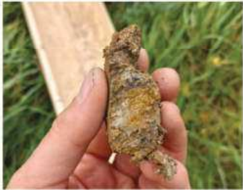
Figure 5 : Traces rédoxiques et réductiques du sondage S16
