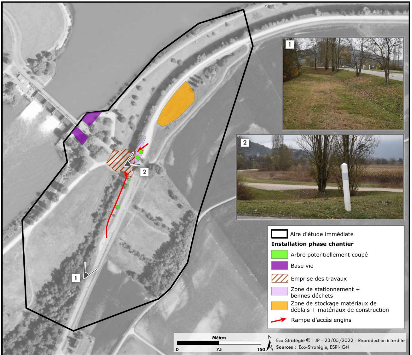
Figure 8 : plan de principe du chantier.
