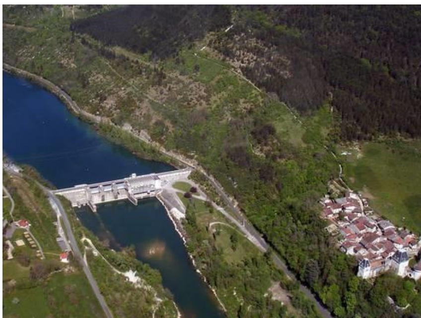
Figure 2 : photos de l'aménagement montrant les trois vannes du barrage en partie centrale, et la centrale hydroélectrique à droite des photos (en rive gauche)
