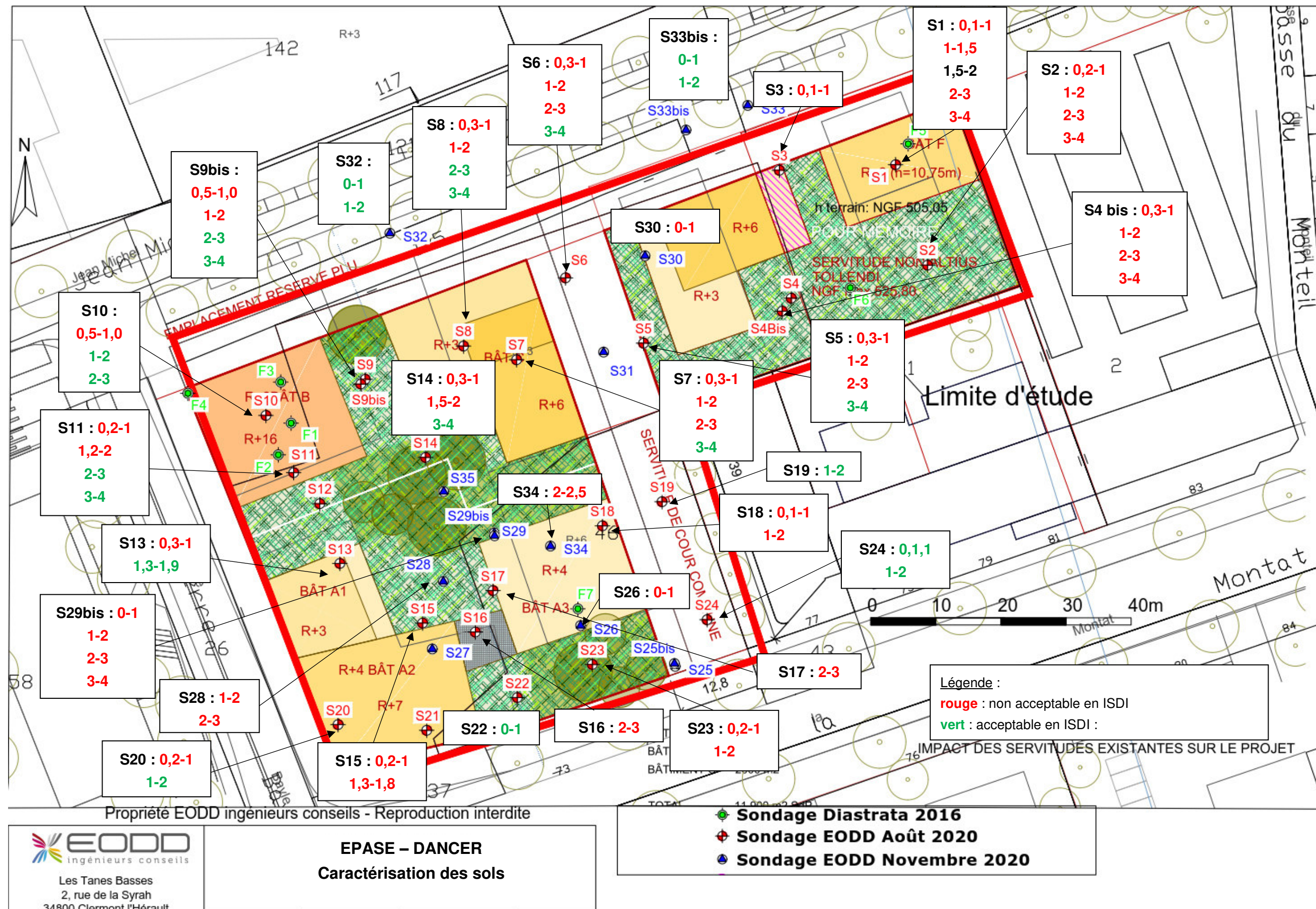
Figure 8 : Dépassements des seuils ISDI
