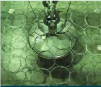
Essais de poinçonnement (ISO 17745:2016)
