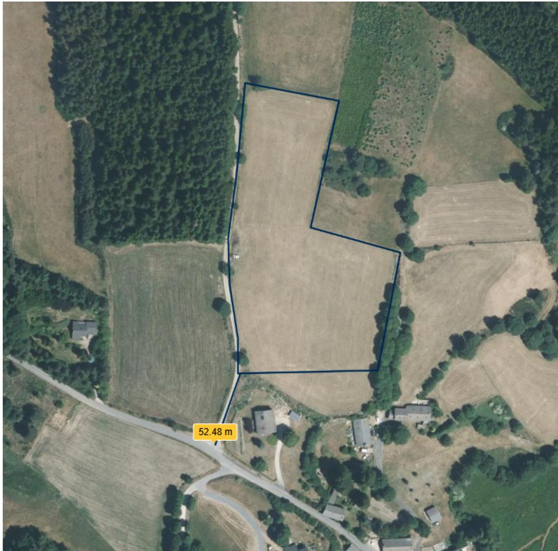
La raccordement pressenti se fera via un branchement à la ligne souterraine HTA passant sur la parcelle BX0287, au bout du chemin d'accès au site, à environ 52 m du Point de Livraison du projet (sous réserve de la décision de travaux d'Enedis).
