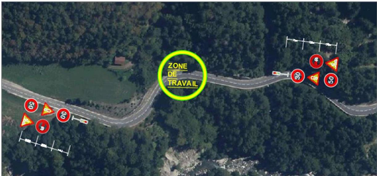
*Plans et principes des alternats de chaussée*
