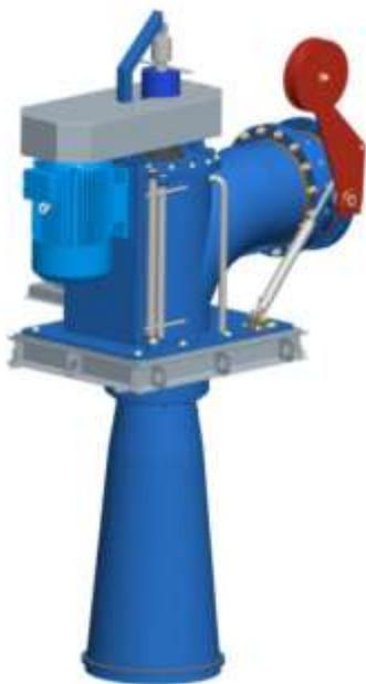
La turbine est un modèle de type semi Kaplan avec une roue de 335 à 4 pales réglables à l'arrêt (ce qui permettra de se caler sur le débit disponible, assez délicat à mesurer). Plus lente, elle tournera à 1000 tr/min, apportant ainsi plus de performance et moins sujette à la cavitation. La génératrice asynchrone Marelli 200 LB6 montée en direct et délivrant environ 16 kW électriques en triphasé 400 V 50 Hz, pour 19 kW à l'arbre à 1000 tr/min.
