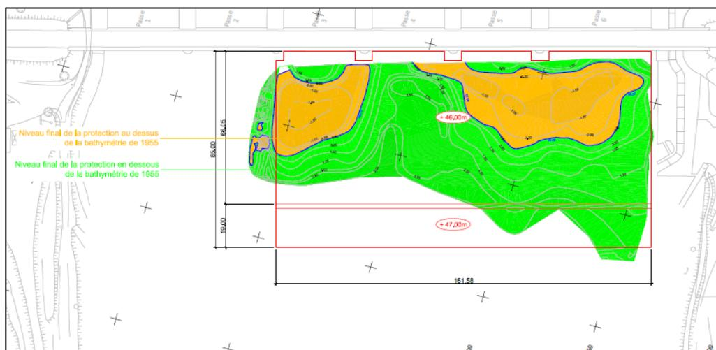
Figure 13 : comparaison du niveau final de la protection par rapport à la bathymétrie de 1955
