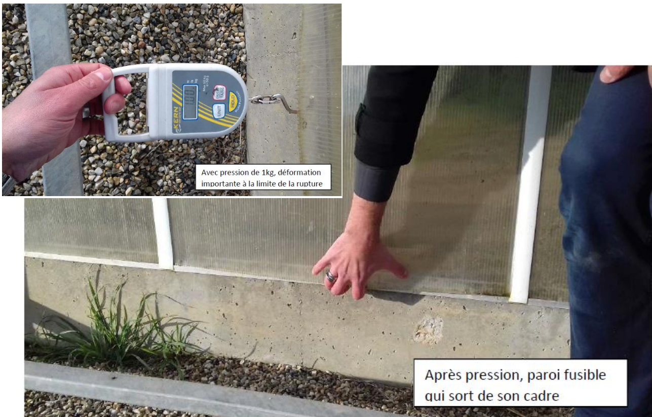
Figure 22 : Réaction de la paroi fusible à la pression
