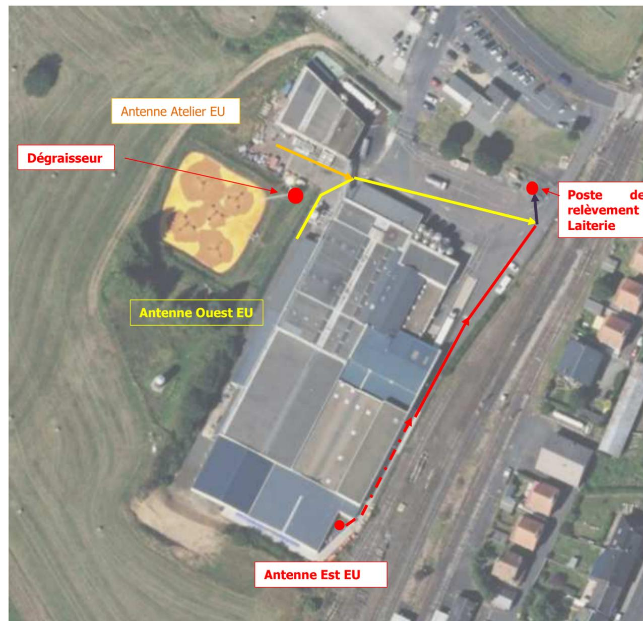
A noter, la présence d'un poste de relèvement interne avec un refoulement sur l'antenne Est EU (pointillé).
