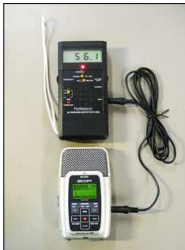
Détecteur manuel Pettersson D240X (en haut) et l'enregistreur Zoom H2 (en bas) utilisés pour cette étude (© Pettersson).
