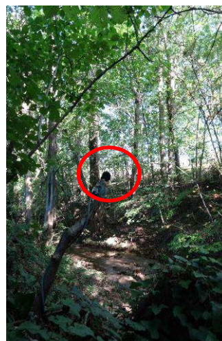
Microphone d'un SM2bat dans la ripisylve du Vallon des Vosges ici déporté 1 mètre au-dessus du sol pour limiter les sons parasites (P. Giraudet ©Biotope).
