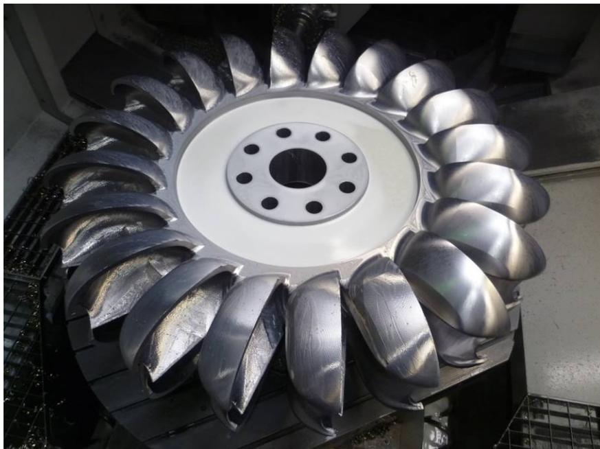
Figure 60 – Exemple de roue de turbine PELTON
