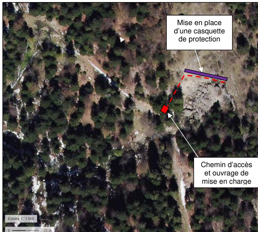
Figure 44 : tracé de la canalisation sur photo aérienne à l'extérieur de la grotte
