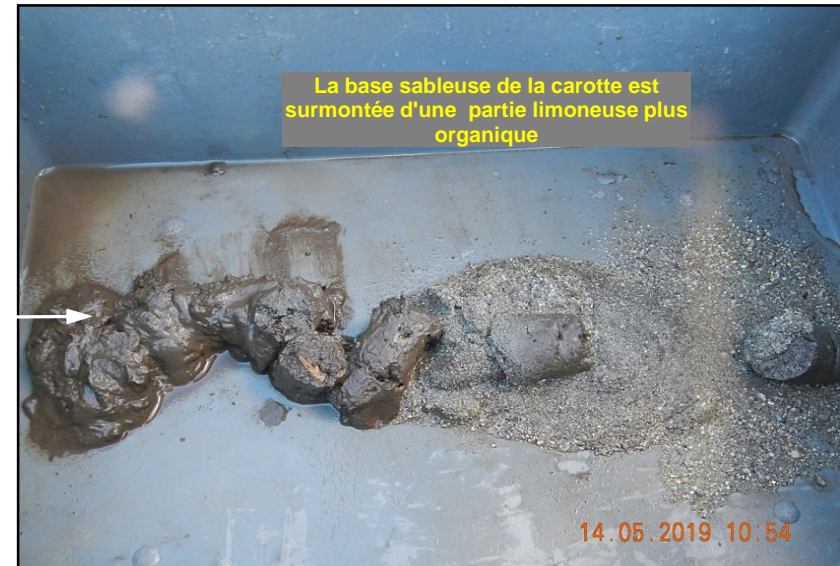
6 - Prélèvement 1c après démoulage de la carotte
