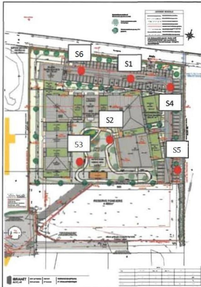
Figure 13 : Carte de localisation des essais de perméabilités (Notice gestion des eaux pluviales, M2C Chantiers, 07/2025)
