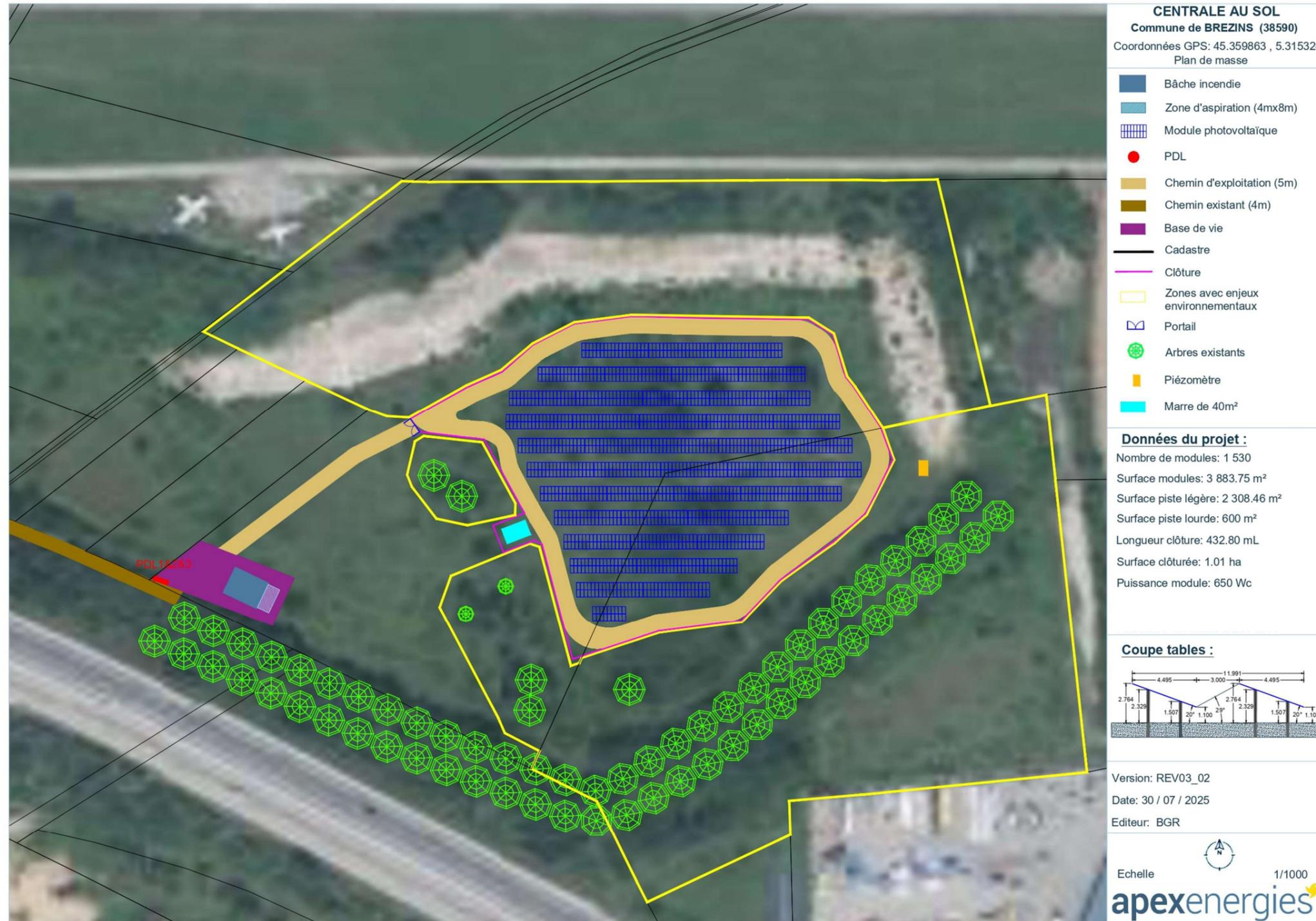
Figure 27 : plan d'implantation de la centrale photovoltaïque
