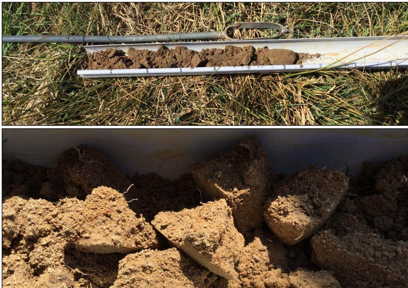
*Figure 23 : Détail du sondage S02 de classe III : vue d'ensemble et détail vers 50 cm*
