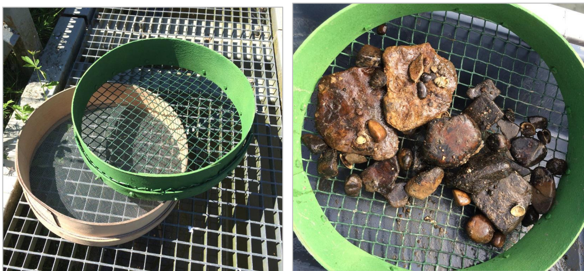
Figure 4 : Tamis utilisés pour isoler la fraction inférieure 2 mm des sédiments
