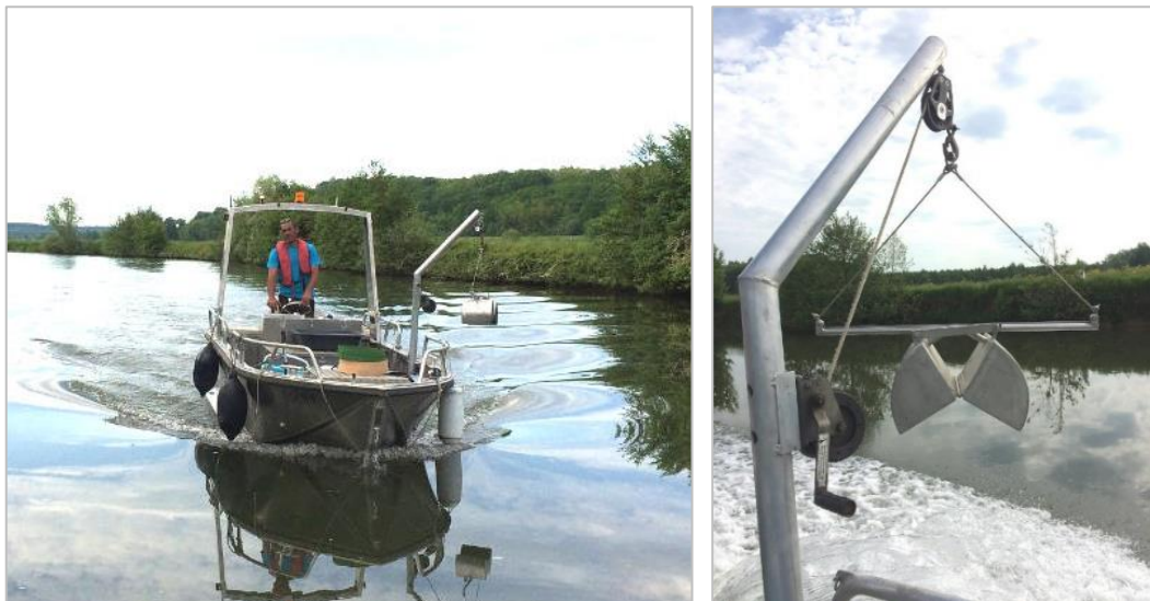
Figure 3 : Embarcation mobilisée et benne preneuse de type Van Veen (CISMA)
