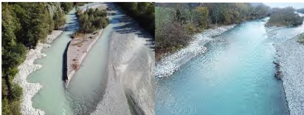
Figure 114 Réinjection sous forme d'épis sur le site de Luzier. A la fin de l'opération (à g.) et 2 ans plus tard (à d.)
