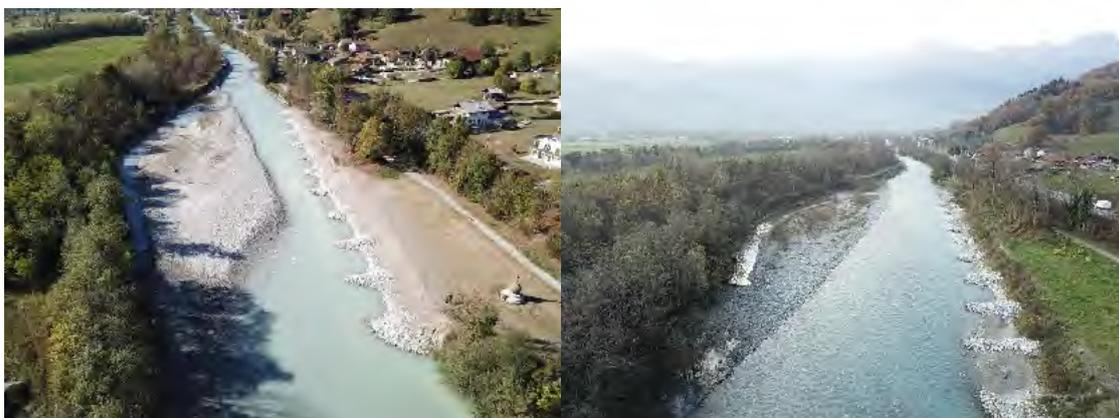
Figure 113 Réinjection sous forme d'épis sur le site de la Carabotte. A la fin de l'opération (à g.) et 2 ans plus tard (à d.)
