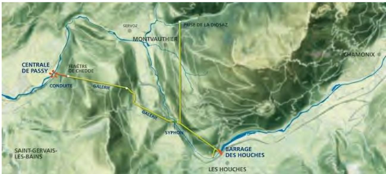
Figure 68 Schéma de l'aménagement hydro-électrique de la centrale de Passy. Source: EDF
