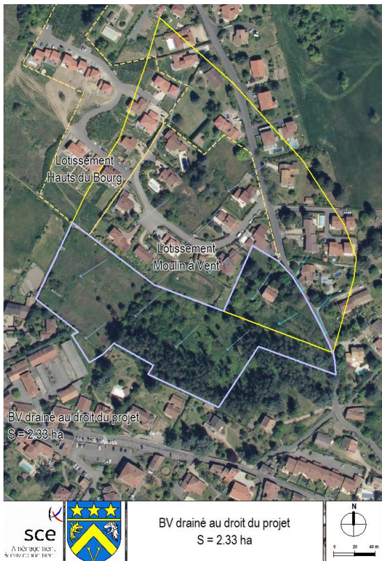
Figure 8 : Impluvium drainé au droit du projet
