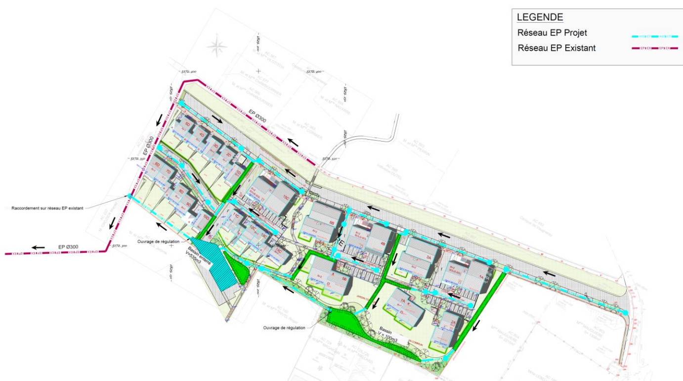
Figure 6 : Principe de gestion des eaux pluviales
