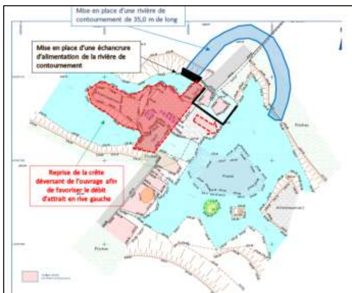
Principes de base de dimensionnement du scénario OH3 - Conservation de l'ouvrage et rivière de contournement
