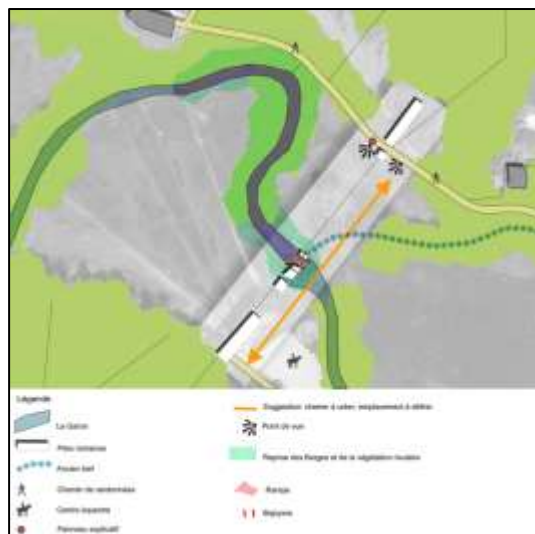
Principes de base de dimensionnement du scénario OH2 - Arasement partiel de l'ouvrage et rampe en enrochements
