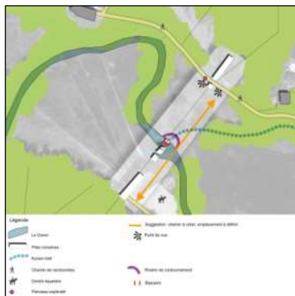
Principes de base de dimensionnement du scénario OH3 - Conservation de l'ouvrage et rivière de contournement
