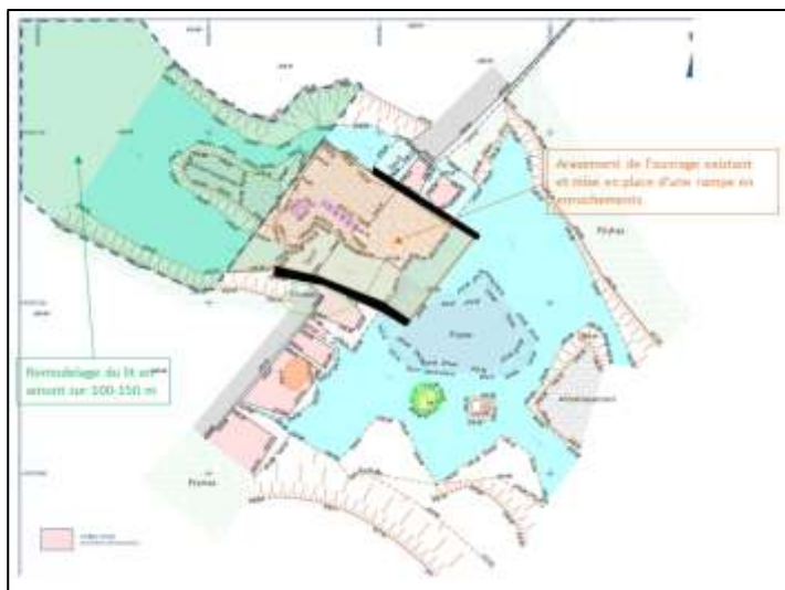
Principes de base de dimensionnement du scénario OH2 - Arasement partiel de l'ouvrage et rampe en enrochements
