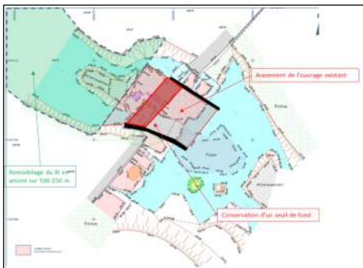
Principes de base de dimensionnement du scénario OH1 – Dérasement ou arasement partiel de l'ouvrage
