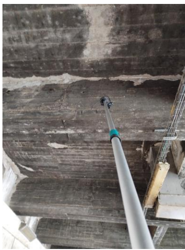
Figure 26 : Passage de l'endoscope à l'intérieur des interstices © Ecosphère
