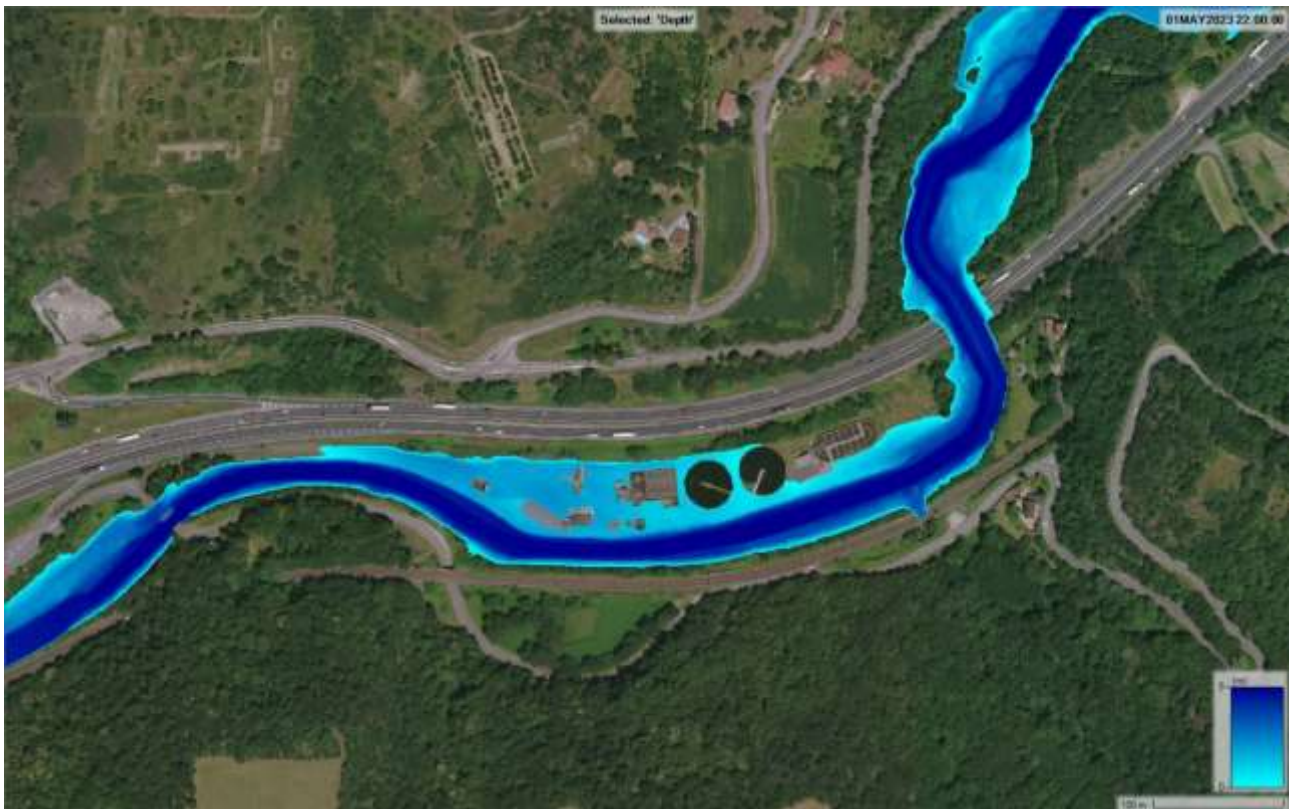
Figure 10 : Hauteurs d’eau en crue centennale - Etat actuel
