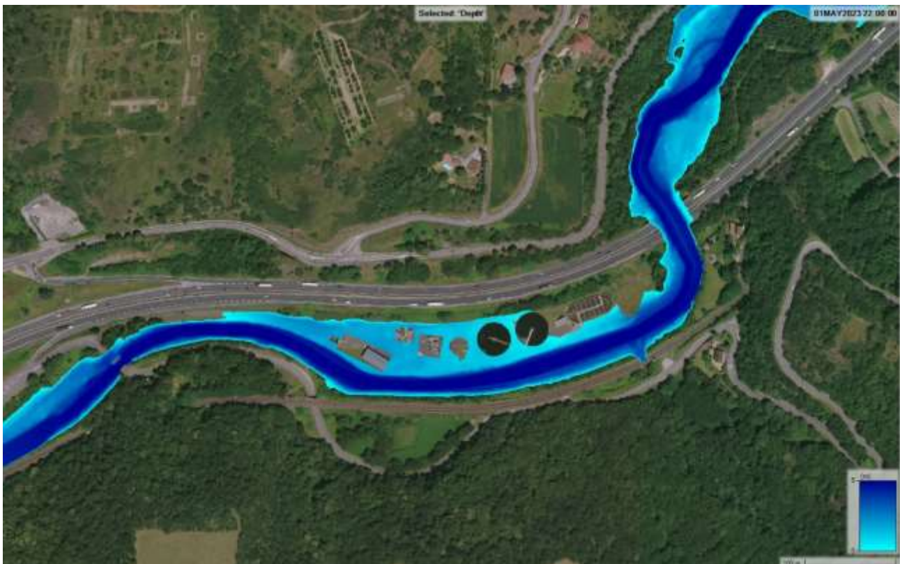
Figure 13 : Hauteurs d'eau en crue centennale - Etat Projet
