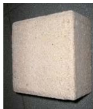
Pavés en béton poreux
