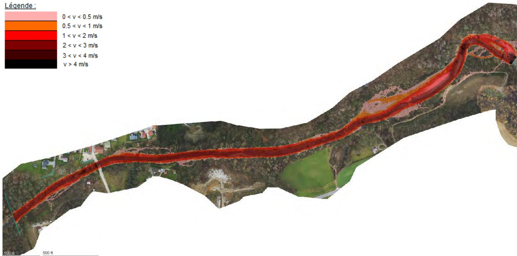
Figure 40 : Cartographie des vitesses maximales d'écoulement dans l'état actuel pour le débit de pointe biennal Q2
