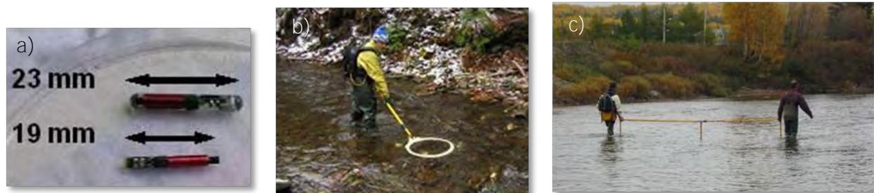
Figure 53 : Pit-tag de 23 et 19 mm (a), petite (b) et grande (c) antennes de recherche
