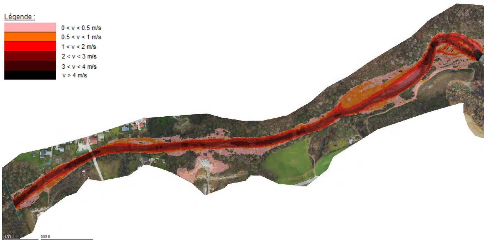
Figure 42 : Cartographie des vitesses maximales d'écoulement dans l'état actuel pour le débit de pointe décennal Q10
