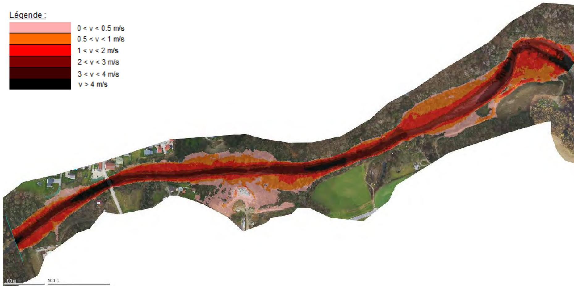
Figure 44 : Cartographie des vitesses maximales d'écoulement dans l'état actuel pour le débit de pointe centennal Q100
