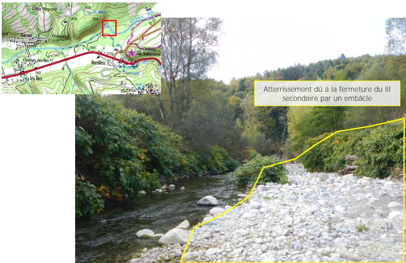
Figure 2 : Les Usse en amont du 1er méandre, où le lit secondaire s'est bouché (HYDRETTUES, 2016)
