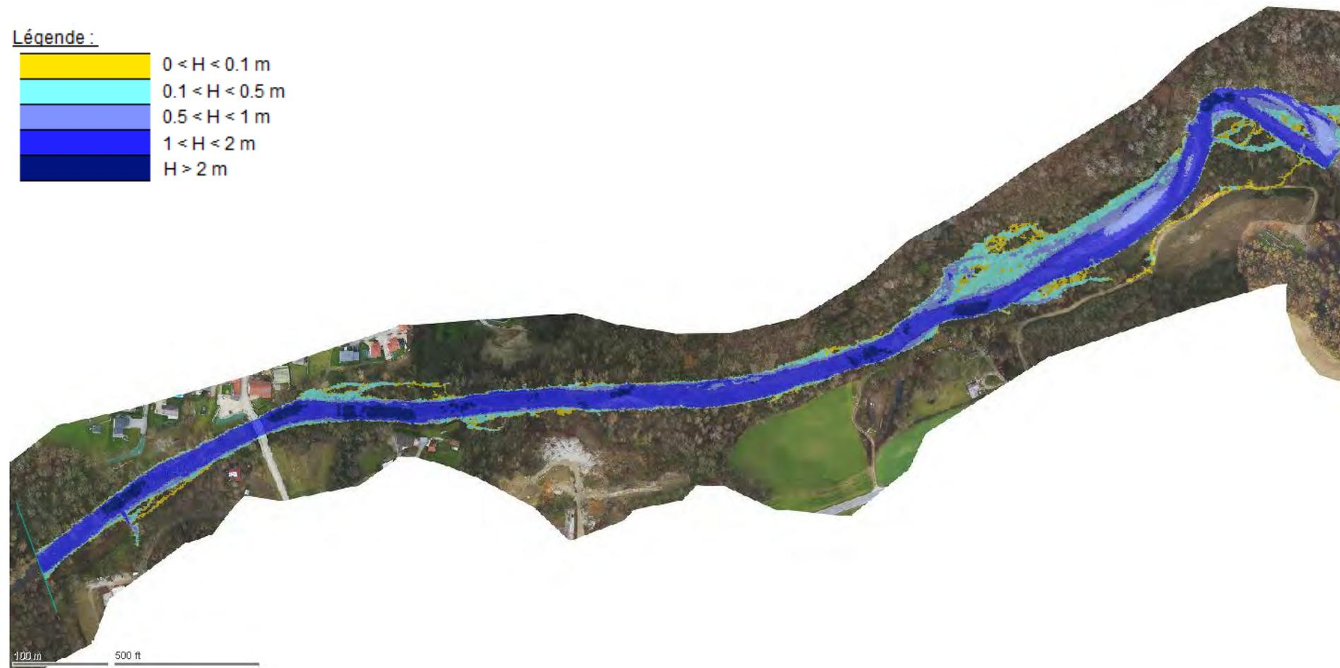
Figure 39 : Cartographie des hauteurs d'eau maximales dans l'état actuel pour le débit de pointe biennal Q2
