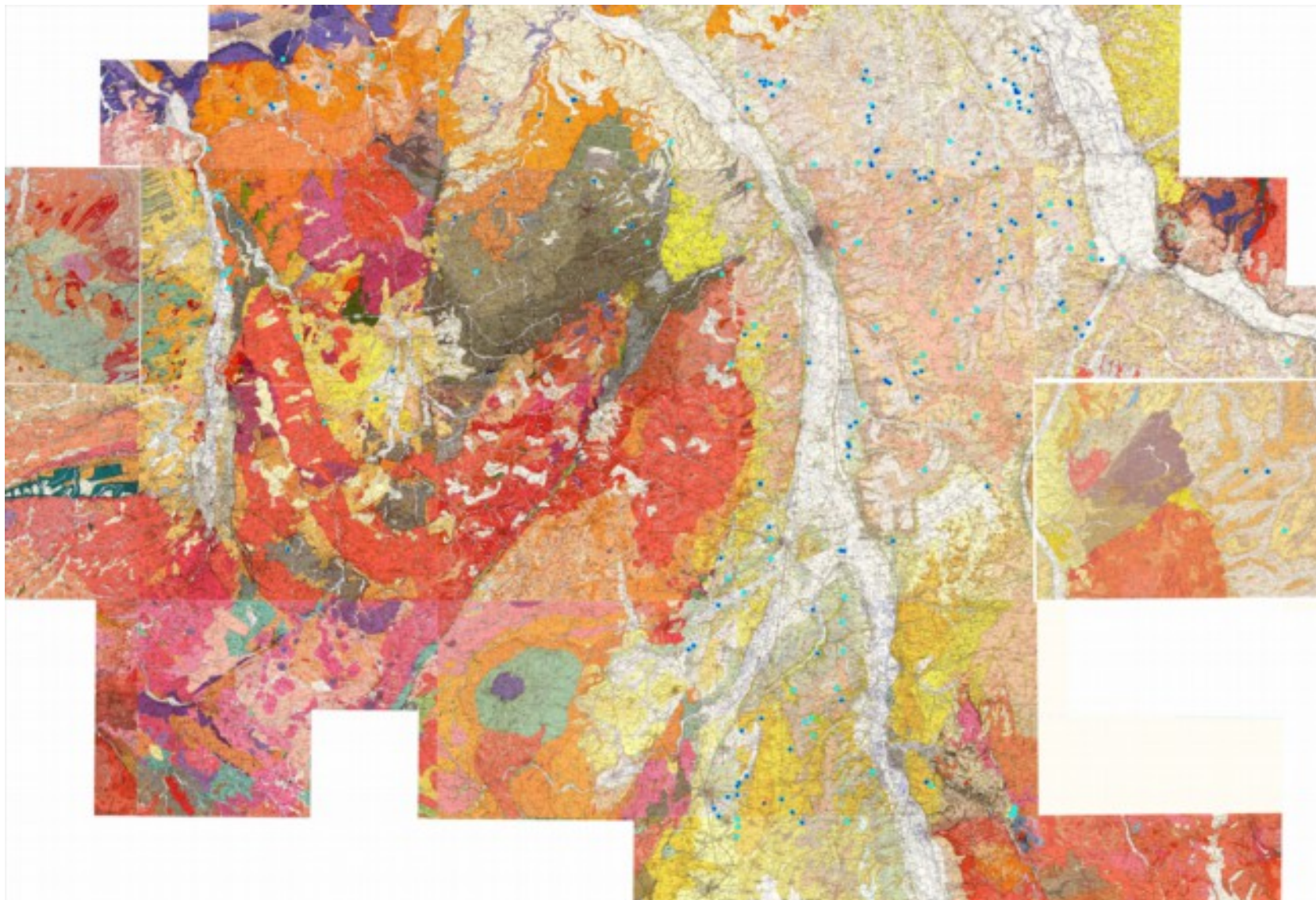
Carte 2 : position des points où des venues d'eau ont été notées à la foration (points ronds bleu clair) et ceux actifs actuellement pour l'exploitation d'eau (étoile bleue).
