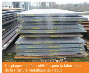
Les plaques de tôles utilisées pour la fabrication de la structure métallique du viaduc
