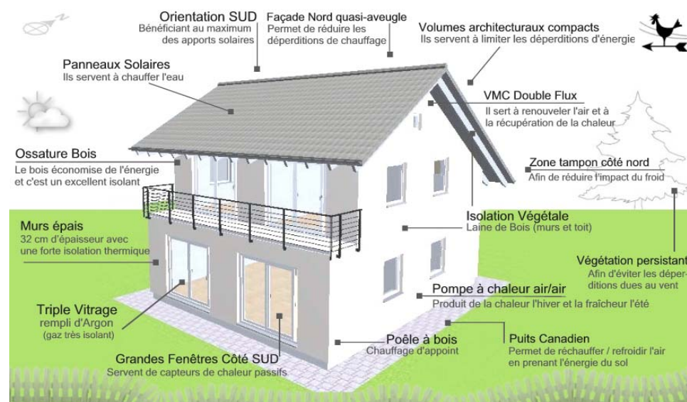
Schéma de synthèse reprenant les dispositifs d'isolation et de production d'énergie actuels, ainsi que les choix constructifs en fonction des différentes expositions Source internet www.active-travaux.com
