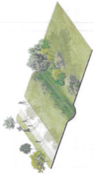
Le chemin, les arbres plantés pour l'ombre, la noue, les haies
