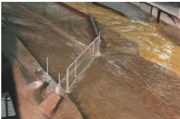
Photo 4 : modèle physique - poutre vue amont
