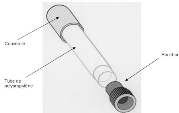
Figure 256 : Echantillonneur passif pour le dioxyde d'azote (Passam)
