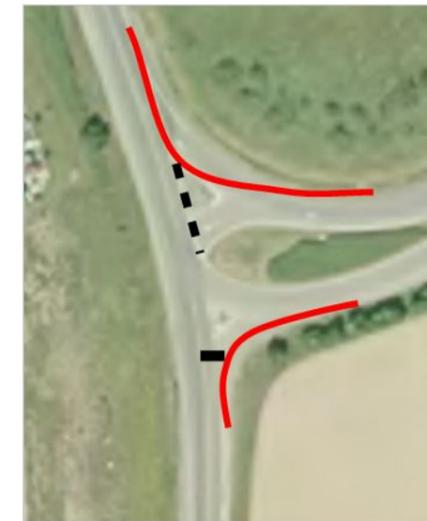
Figure 37 : Carrefour Plovier Sud, mise en place d'un stop
