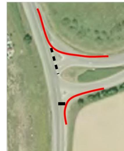
Figure 38 : Carrefour Plovier Sud, mise en place d'un stop
