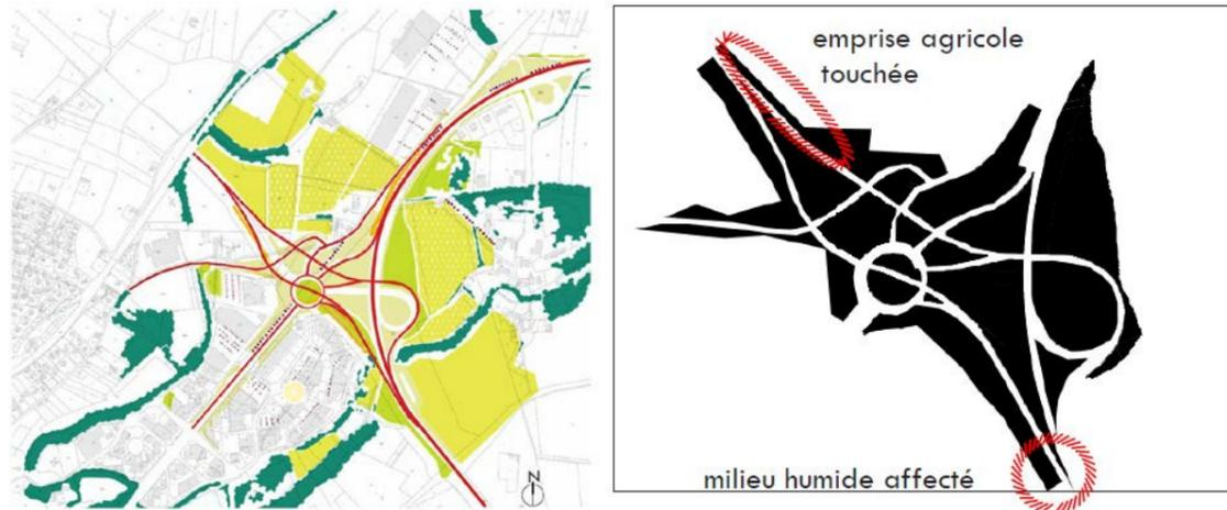
Figure 17 : Impacts du projet routier avec la solution 2
