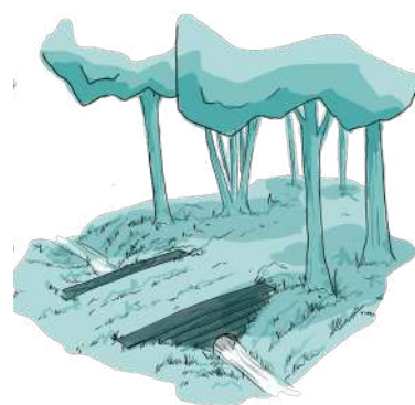
Franchissement de noue/fossé avec soubassement en poutre bois
