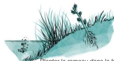
Planter le rameau dans la berge, (1/3 dans le sol ; 2/3 en dehors) attention aux bourgeons et à la localisation des nœuds.
