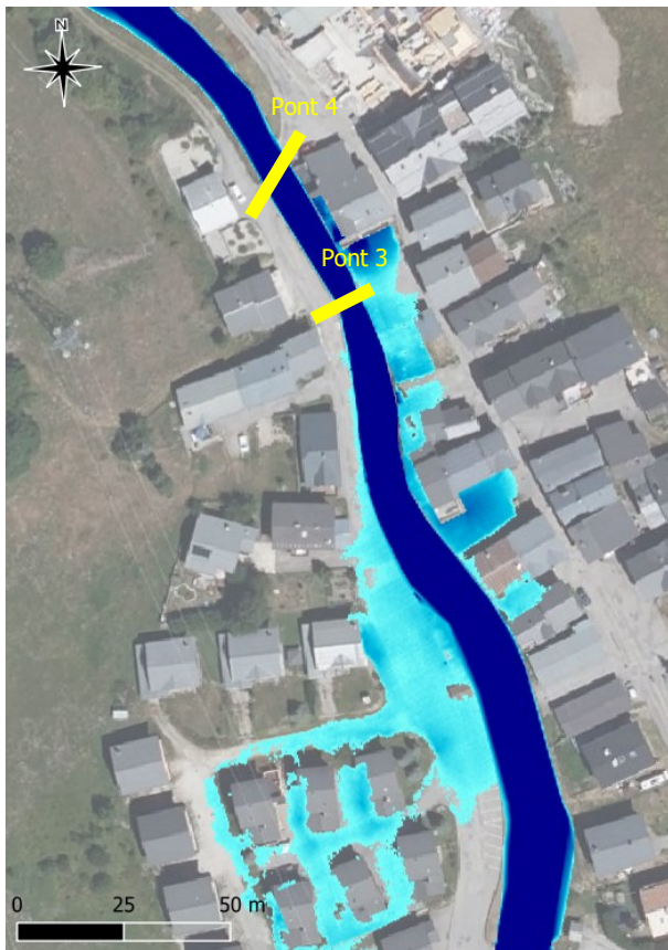
Figure 80 : Cartographie des débordements – état initial Q100 sans engrèvement
