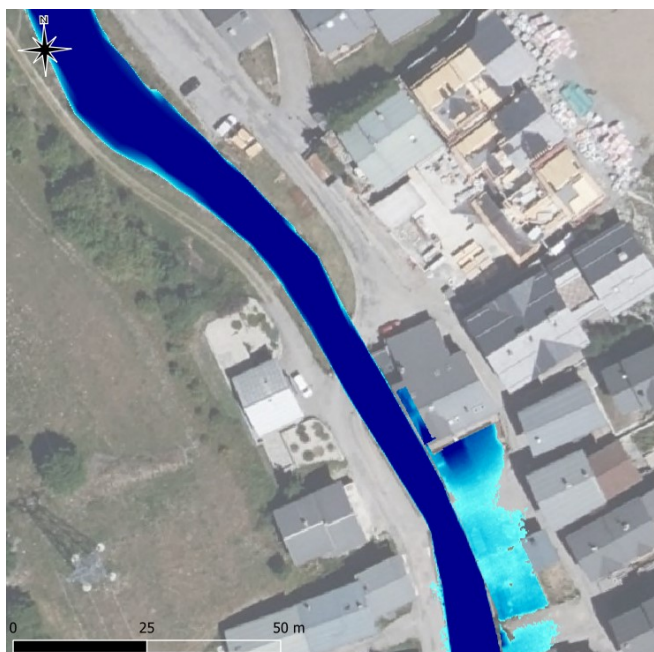
Figure 94 : Cartographie des débordements – état initial Q100 sans engravement
