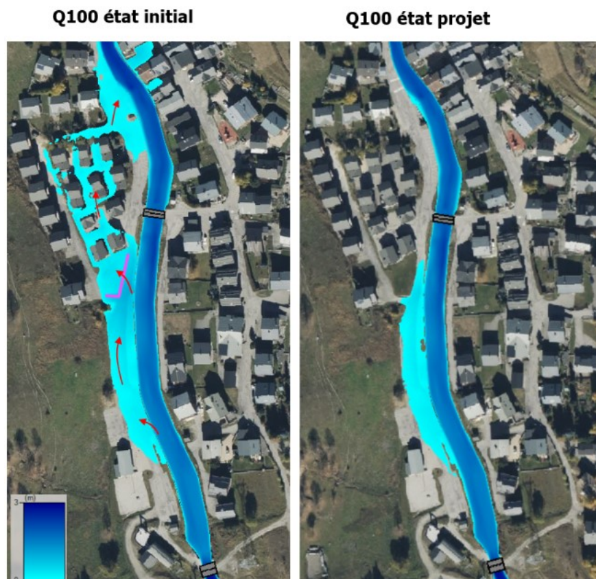
Figure 75 : Cartographie des zones de débordements en Q_{100} à l'état projet VS état initial
