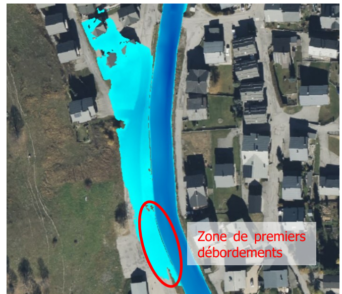
Figure 57 : Zone de premiers débordements en rive gauche (2/2)
