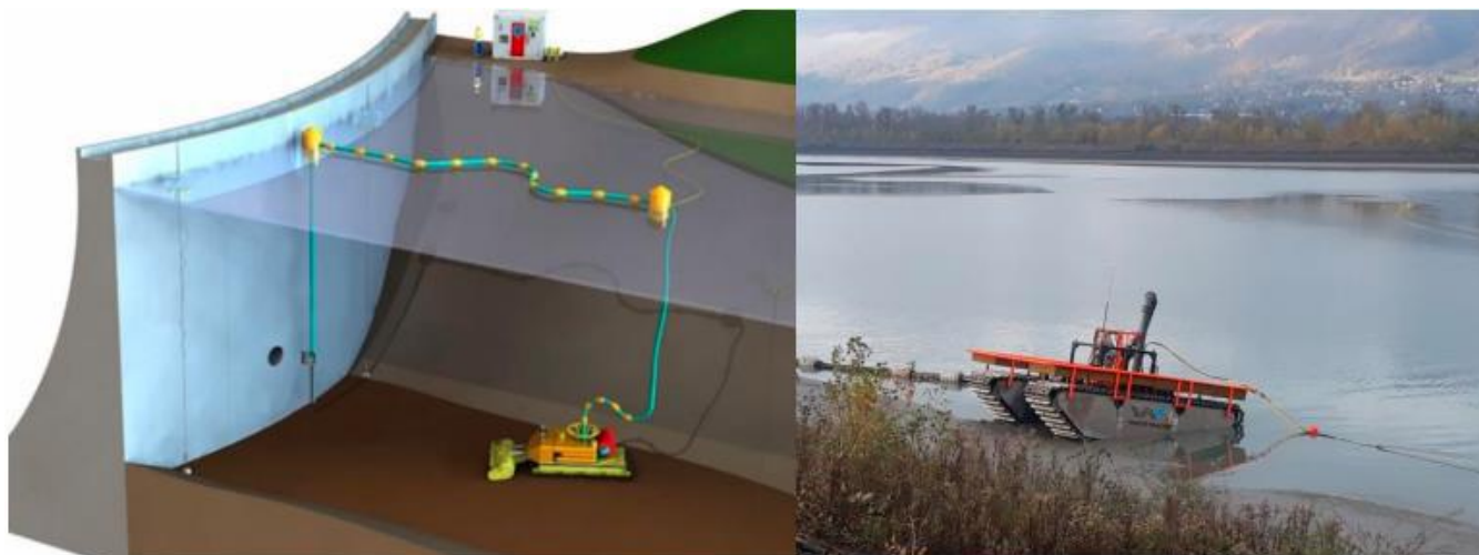
Figure 12 : Principe de fonctionnement du robot NESSIE (Source : Egis et EDF)
