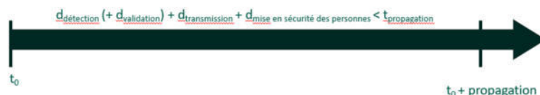
Figure 3 : généralités sur la mise en place d'une organisation basée sur l'alerte. Le phénomène de vidange début à t_0 , il faut un certain temps pour le détecter ( d_{détection} ) pour éventuellement valider la détection ( d_{validation} ) pour transmettre l'information de détection ( d_{transmission} ) et un certain temps pour mettre en place la solution d'organisation retenue (par exemple déplacer les personnes en sécurité). A t_0 + t_{propagation} , le phénomène arrive au niveau des enjeux. [éléments préparés pour le COPIL n°1 du 16 juin 2023]
