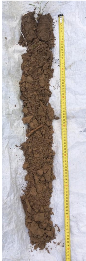
Sondage n°1 à gauche et n°2 à droite, absence de traces d'hydromorphie, brunisols
