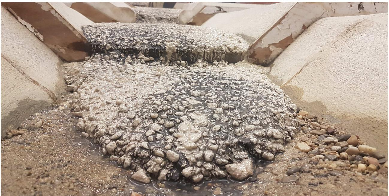
**Photo 29** : Effet du seuil de début de mouvement sur le modèle réduit du Manival (CNR).
