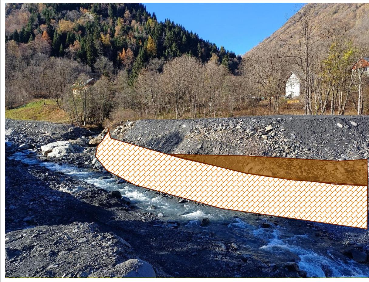
Figure 16: Schéma de la protection rive gauche à la confluence Tepey-Glandon
