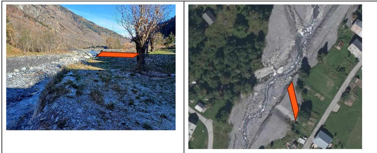
Figure 17: Illustration de l'épi à réaliser en rive droite pour ramener les écoulements vers le lit du Glandon et de la forme d'entonnait souhaitée
