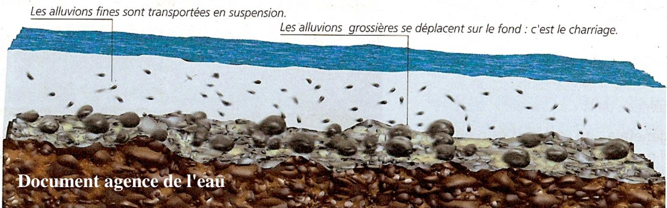
**Figure 15** : Différents types de transport solide en rivière.
