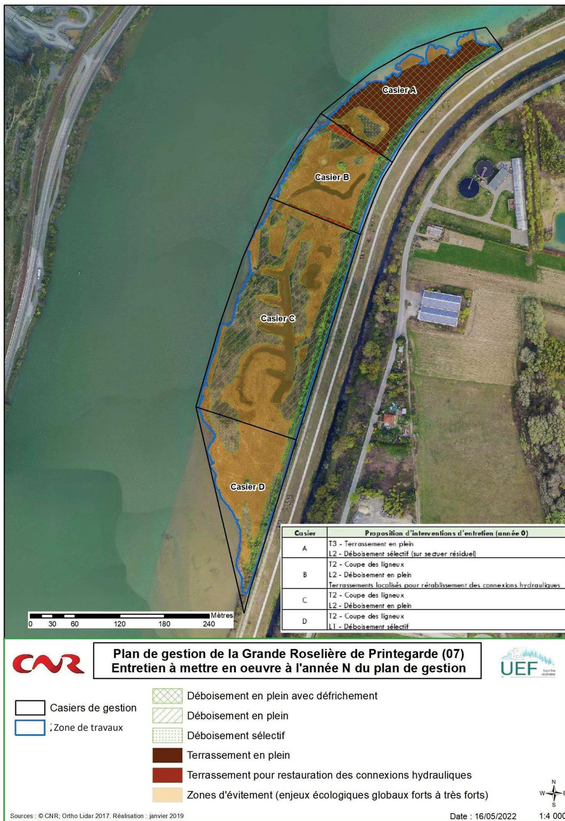
Figure g8 : Entretien à mettre en oeuvre à l'année N du plan de gestion. Cette carte localise les différents entretiens (terrassement et végétation) ainsi que les travaux complémentaires concernant l'entretien des parements des digues et non pied et les connexions hydrauliques entre les casiers.
