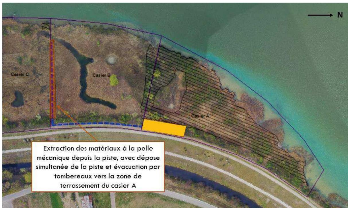
Figure 36 : Etape 2 – terrassement du merlon entre casiers B et C
